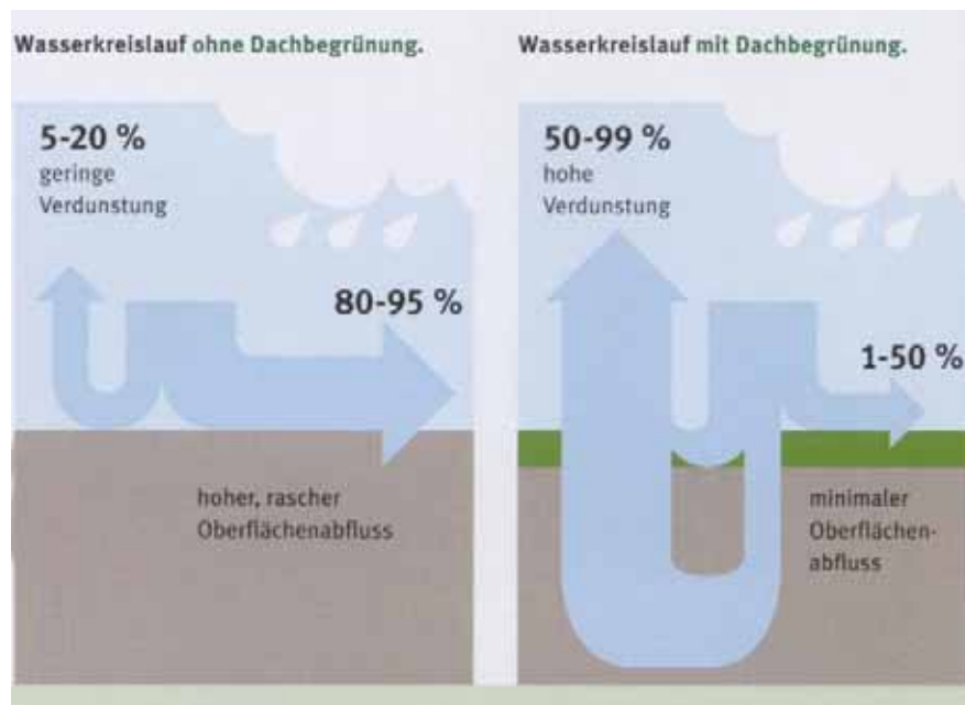
Abbildung 1: Wasserkreislauf ohne und mit einer Dachbegrünung. © Optigrün
